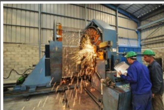
Préparation d'une cage d'armature pour tuyau de fonçage Usine LA MEDITERRANENNE DU BETON 30/11/2011
